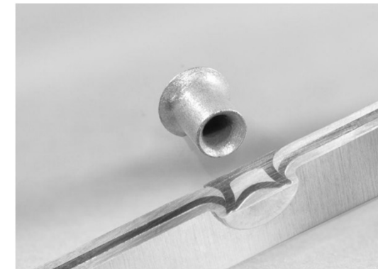
Fasi del processo di Rivettatura Autoperforante
